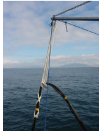
Figure 11 : hydrophone immergé à partir d'un bateau a. bateau à l'arrêt b. utilisation d'un élastique pour amortir les mouvements du bateau
